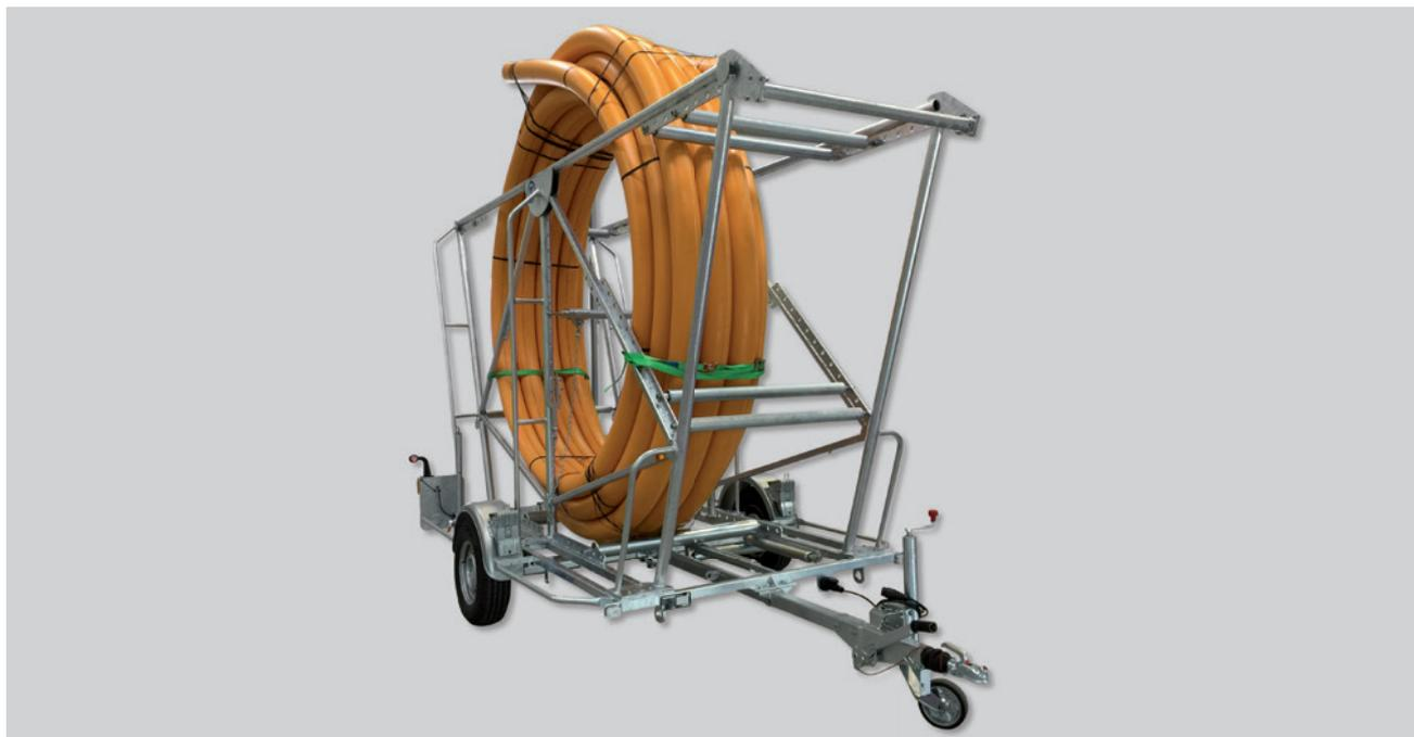
Der Anhänger wird in zwei Gewichtsklassen gefertigt. Als Typ **RVL 916** mit einer Zuladung von 900 kg und **RVL 1616** mit einer Zuladung von 1400 kg können die Fahrzeuge Rohrbunde mit einem max. Durchmesser von 180 mm und einer Länge von 100 Metern transportieren.
