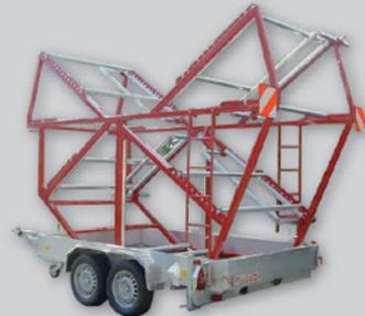
**Transport- und Abrollkorb für Kunststoffrohr-Ringbunde, aufgesetzt auf einem Tandem-Anhänger**
