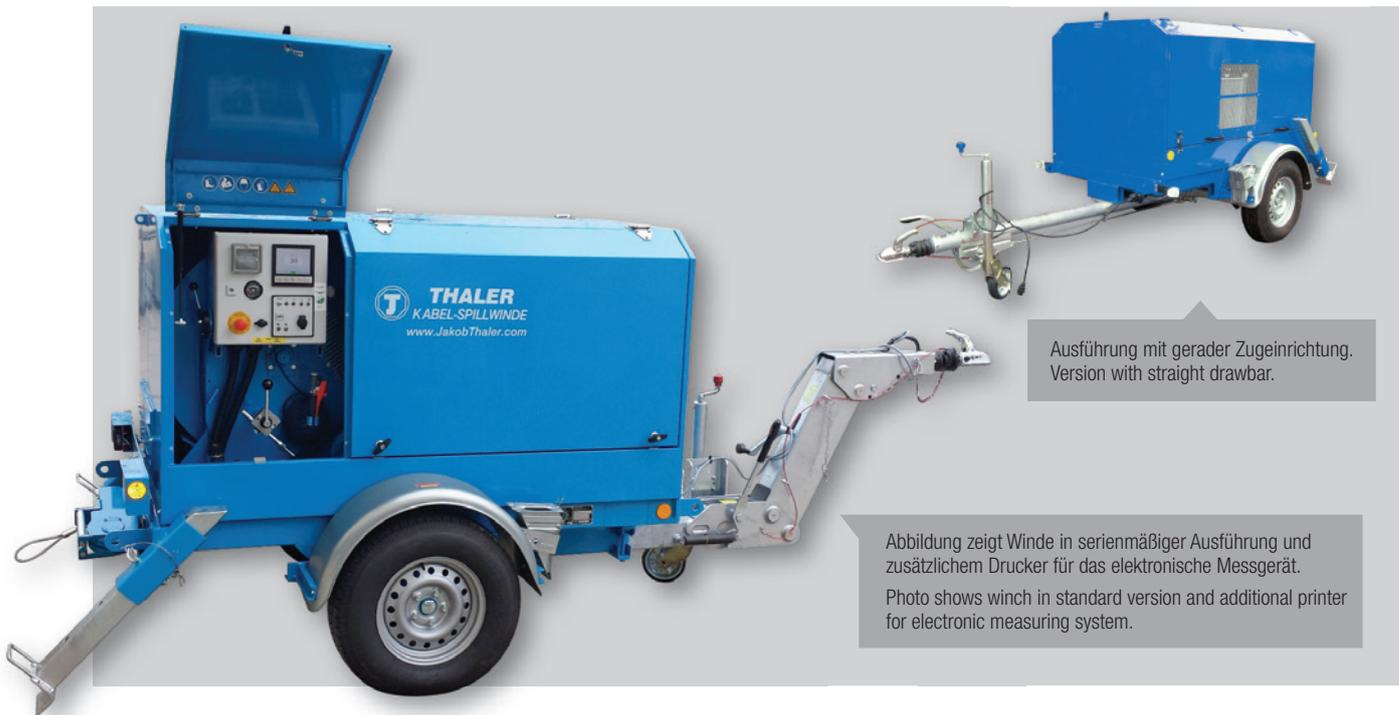
Ausführung mit gerader Zugeinrichtung.
